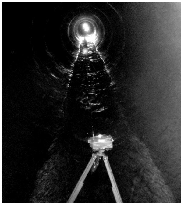
Рис.2 Дипольный индуктивный структуроскоп СДИ К-5
